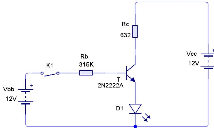
حيث:  $R_c=632\Omega$  ,  $V_{d1}=1.90v$  ,  $V_{bb} =12v$  ,  $V_{cc} =12v$  ,  $V_{be}=0.6v$  ,  $V_{ce}=6v$  ,  $\beta=217$  ,  $R_b= 315 k\Omega$  ,
